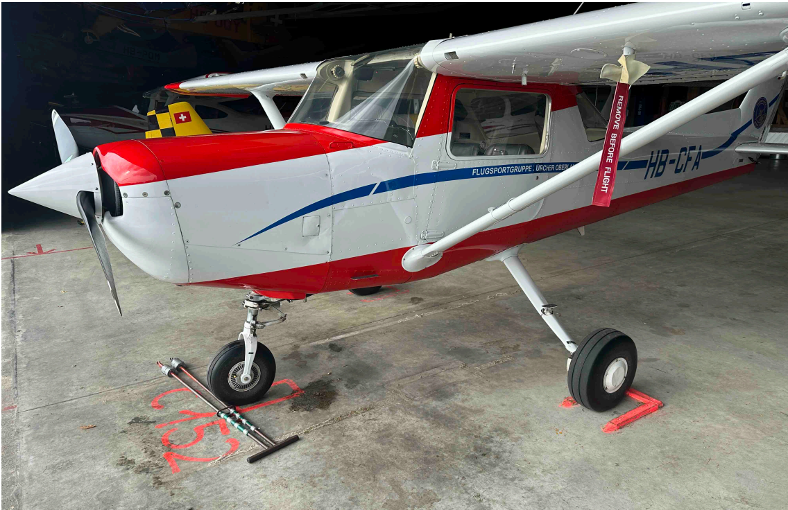
Cessna C152 an der richtigen Parkposition, Stange als Radschuh korrekt positioniert, linkes Hauptfahrwerk in der vorgesehenen Mulde.
