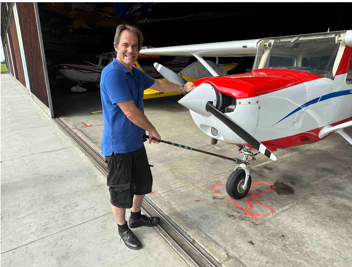
Tow Bar (Stange) montiert, Hand an der Propellerwurzel: So geht's am besten zum Schieben / Stossen
